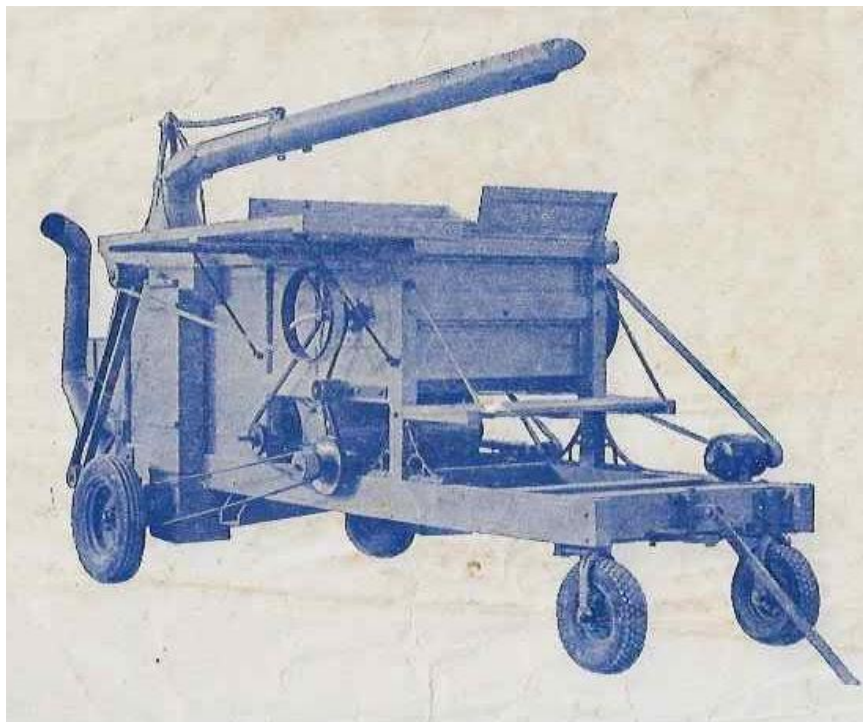
En aquesta imatge es pot observar la incorporació del motor elèctric.
